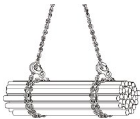
Obrázek 11: dvojitě vázání ve stejném směru
