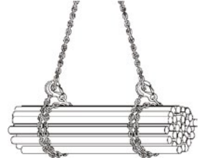
Bild 11: doppelt geschnürt gleichsinnig
