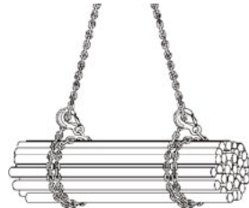
Rysunek 11: podwójnie sznurowany w tym samym kierunku
