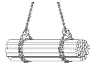
Afbeelding 13: dubbel gestropt in tegengestelde richting
