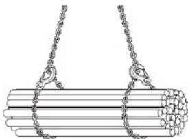
Bild 12: enkelt surrad i motsatt riktning
