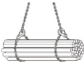
Figura 12: allacciamento semplice in senso contrario
