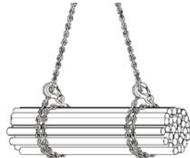
Figura 11: allacciamento doppio nello stesso senso
