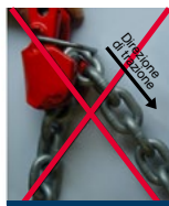
Catena agganciata in modo errato
