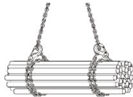
13. ábra: duplán átfűzött ellentétes irányba
