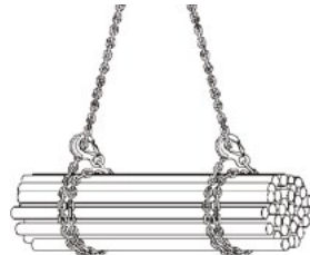
Bild 11: dubbelt surrad i samma riktning
