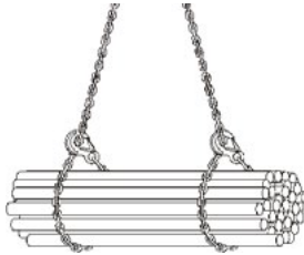
Afbeelding 10: enkelvoudig gestropt in dezelfde richting
