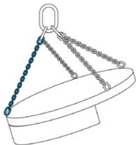
Rysunek 14: Duża część ładunku jest utrzymywana przez jedno pasmo łańcucha
