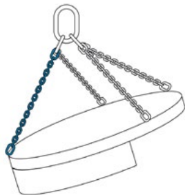
Obrázek 14: Největší část zátěže nese jeden pramen řetězu
