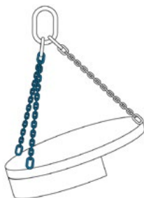
Figura 15: Gran parte del carico è sorretto da due trefoils della catena
