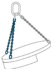
Figura 15: A maior parte da carga é suportada por dois ramais de correntes
