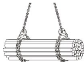
Obrázek 13: dvojitě vázání v opačném směru
