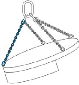
Illustrasjon 14: Størstedelen av godset bæres av én kjettingpart
