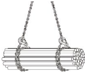
11. ábra: duplán átfűzött azonos irányba
