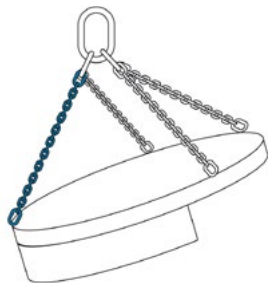
Figura 14: A maior parte da carga é suportada por um ramo de correntes
