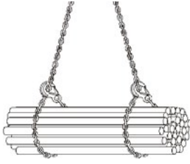
Bild 10: einfach geschnürt gleichsinnig
