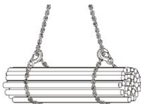
Figura 12: estrangulamento simples no sentido contrário
