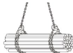
Figura 13: estrangulamento duplo no sentido contrário
