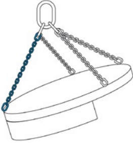
Fig. 14: Størstedelen af lasten bæres af en kædepart
