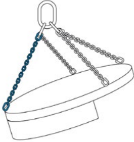
Ilustración 14: Un ramal de cadena lleva la mayor parte de la carga.
