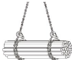
Figura 11: estrangulamento duplo no mesmo sentido
