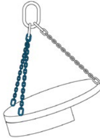
Bild 15: Der Großteil der Last wird von zwei Kettensträngen getragen
