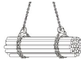
Ilustración 13: atado doble en el sentido contrario
