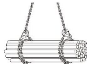
Figura 13: allacciamento doppio in senso contrario
