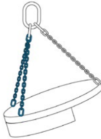
Illustrasjon 15: Størstedelen av godset bæres av to kjettingparter
