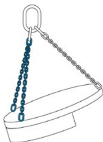
Rysunek 15: Duża część ładunku jest utrzymywana przez dwa pasma łańcucha
