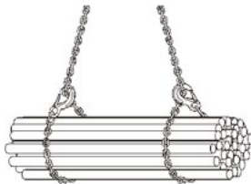
Ilustración 12: atado simple en el sentido contrario
