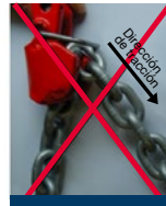
Cadena mal enganchada
