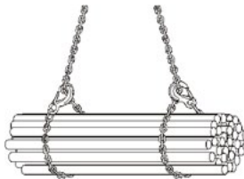
Afbeelding 12: enkelvoudig gestropt in tegengestelde richting
