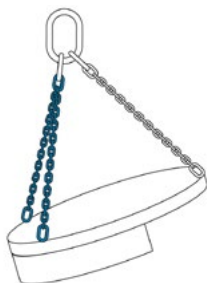
Obrázek 15: Většinu zátěže nesou dva prameny řetězu
