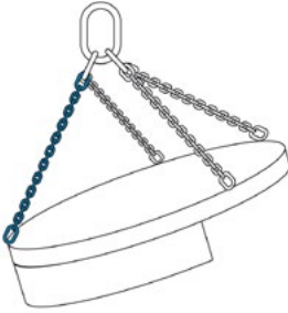
Afbeelding 14: Het grootste deel van de last wordt door 1 kettingstreng gedragen
