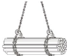
Ilustración 11: atado doble en el mismo sentido
