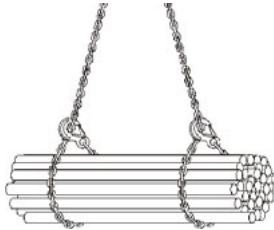
Figure 10: Couissant dans la même direction
