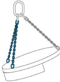
Fig. 15: Størstedelen af lasten bæres af to kædeparter
